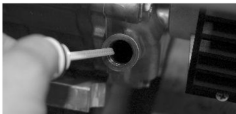
Fot. 1 Sprawdzenie poziomu oleju w silniku jednocylindrowym Honda i Mitsubishi
