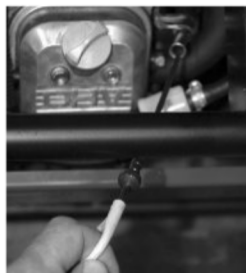
Rys.2 Sprawdzenie poziomu oleju silniki HONDA i MITSUBISHI (jednocylindrowe)
